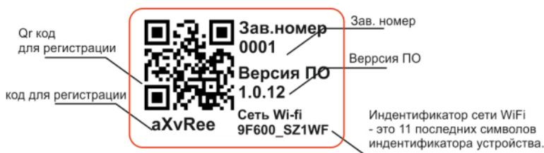
Рисунок 2. – Наклейка модуля.
