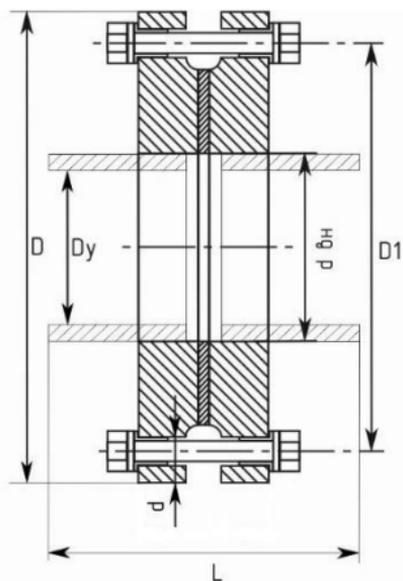
Рисунок 2 - Изолирующее фланцевое соединение ИФС-А
