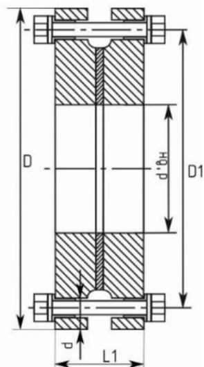
Рисунок 4 - Изолирующее фланцевое соединение ИФС-В
