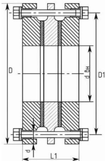
Рисунок 3 - Изолирующее фланцевое соединение ИФС-Б
