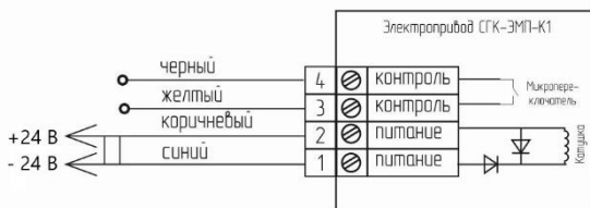
Рис2. Схема соединения СГК-ЭМП-К1
